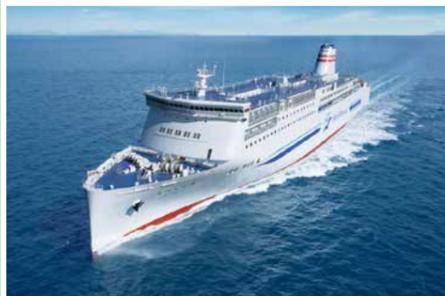
2017年3月「らべんだあ」6月「あざれあ」が新潟～小樽間に就航。同航路で14年ぶりとなる新造船は個室を大幅に増やし、露天風呂やペットと同伴できる「ウィズペットルーム」を完備。また国内フェリーとしては初の垂直船首を有する省エネ船型近接2軸推進システムとバルブ付リアクション型舵を組み合わせた省エネ推進システムを採用しており、従来船と比べ約10%省エネ効果を高めることができます。
