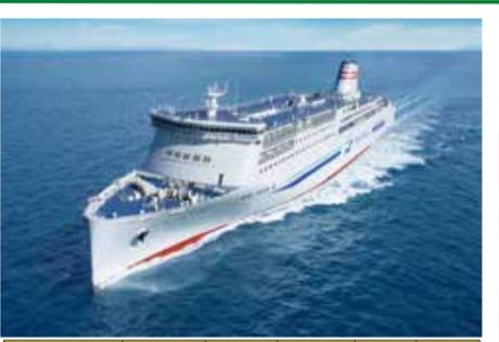
2017年3月「らべんだあ」6月「あざれあ」が新潟～小樽間に就航。同航路で14年ぶりとなる新造船は個室を大幅に増やし、露天風呂やベットと併せて「ウィズベトルーム」を完備。また国内フェリーとしては初の垂直船首を有する省エネ船型近接2軸推進システムとバルブ付リアクション型舵を組み合わせた省エネ推進システムを採用しており、従来船と比べ約10%省エネ効果を高めることができます。
